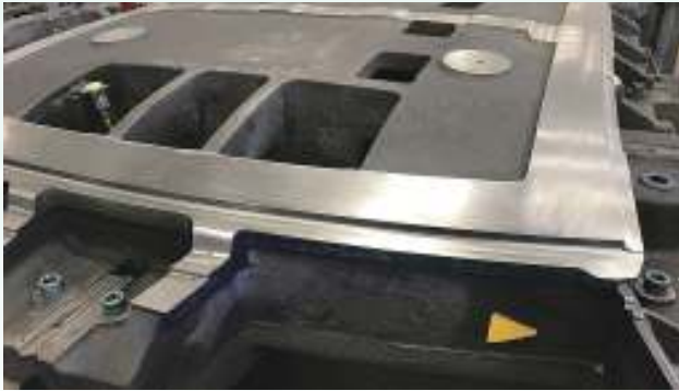
図3 OEM供給メーカーが使用する自動車用トリム金型の例。この金型のサイズは177×95×54インチ(4.5×2.4×1.4m)で、重量は9万3000ポンド(4万2200kg)。
