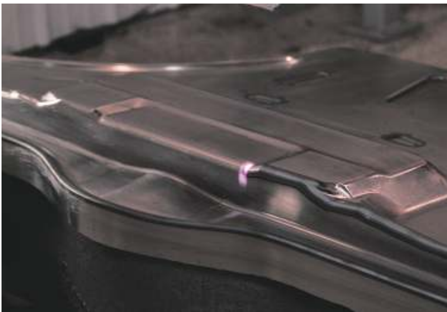
図1 自動車用フロントガード側スタンピング金型のレーザー熱処理を実際に行っている様子。
