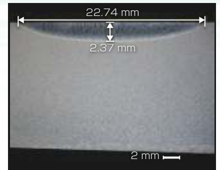
図2 レーザー熱処理を施したS7140合金鋼金型の金属断面図。
