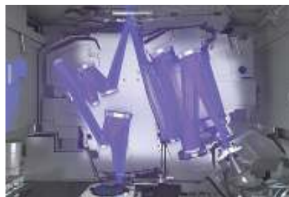
図1 ASML社のEUVリソグラフィスキヤナ内部に13.5nm波長で機能する反射光学系がある。EUV光源は右下、マスクは上方。(画像提供:ASML社)
