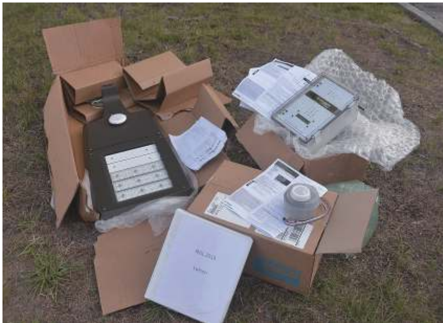
図6 PNNLの駐車場プレゼンス検出システムに取り組むチームは、照明器具、センサ、コントローラなどの技術を導入するにあたって、かなりのシステム統合を行う必要があった。(写真提供: PNNL)
