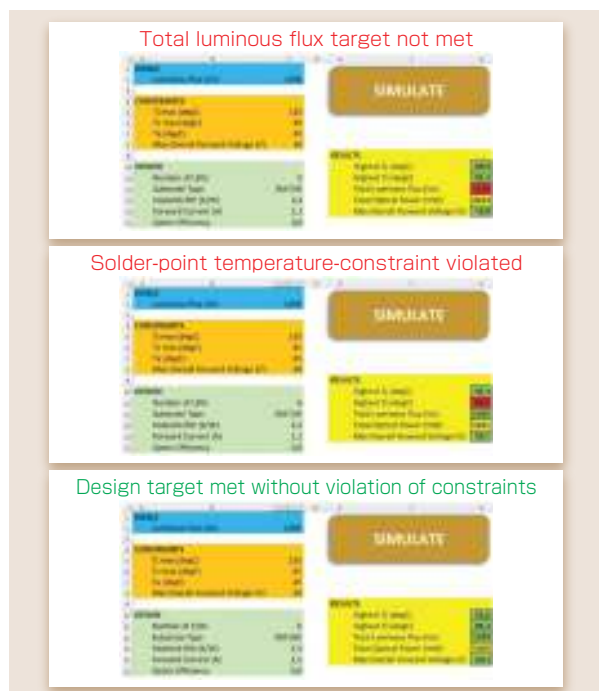
図2 スプレッドシートベースのアプリケーションにより、Delphi4LED方式のコンパクトモデルを使用した仮想プロトタイピングによる、基本的な照明器具設計選択肢の評価を行うことができる。
