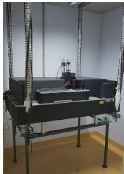
図3 自家製除振システムは、低周波とある振動自由度で市販製品を上回っている。
