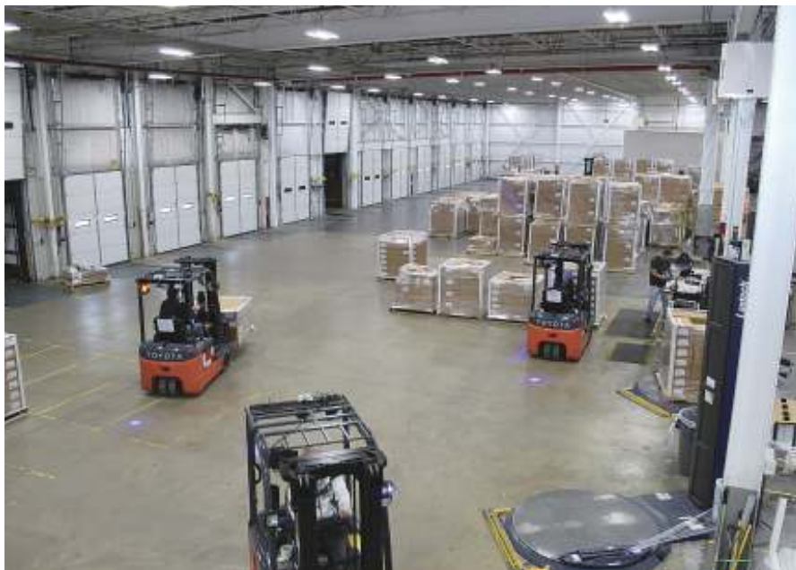
図3 カレント社の屋外照明工場の出荷エリアでは、可視光通信 (VLC) によって、フォークリフト、ひいては最終製品の屋内位置特定が行われている。
