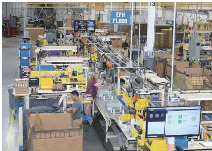
図2 ノースカロライナ州ヘンダーソンビルにあるカレント社のリーンな製造施設は、幅広い種類の注文に対応できるように、製造ラインがほぼモジュール式の要素で構成されている。
