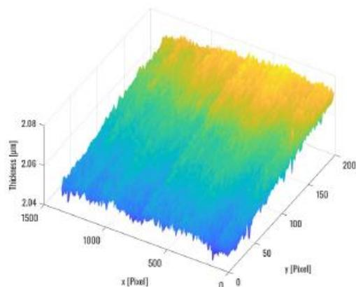
ウェハーの電極表面の厚さ測定
