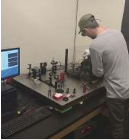
図2 オプティマクス社のエンジニアは、光熱共通経路干渉計 (PCI) を使ってコーティングの吸収を計測する。(提供: オプティマクス社)
