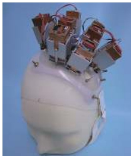
図7 多方向fNIRSのモジュール (18) (OSAから許可を得て転載)。
