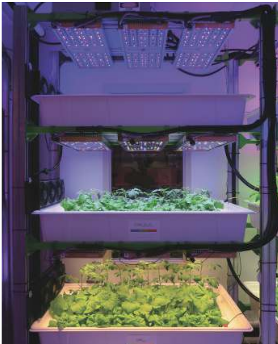
図3 ランクル氏のControlled Environment Lighting Laboratory (CELL)には、独オスラム社 (Osram) の研究用に開発された7チャンネルのSSLシステムが導入されている。(写真提供: ミシガン州立大CELL。撮影者: キンウー・(ウィリアム)・メン氏 (Qingwu (William) Meng))
