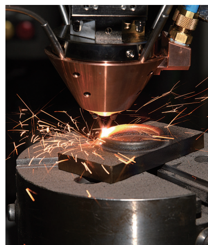
図1 産業用ハイパワー半導体レーザーシステムは、改良されたビームデリバリ光学系、コンパクトなラックマウント構成および簡素化された冷却機能により強化されている。
