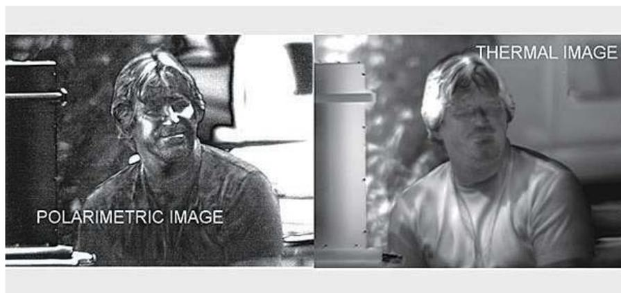
図3 標準的な偏光サーマルカメラを使って人物特定例をデモンストレーション。サーマル偏光画像により、微細な顔の細部が顕現する、と研究者は説明している。(写真提供:U.S.Army Photo)
