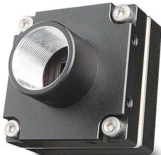
図1 FLIR Firefly。業界初のマシンビジョン対応カメラ。ディープラーニング（DL）を用いる画像解析プロ用に設計されている。基本的なマシンビジョン機能をDLパワーと組み合わせている。小型で低電力であることは、ポータブルデバイスにとって理想的で、最新のグローバルシャッターCMOSセンサーで抜群の画像処理を行う。また、Intel Movidius™ Myriad™ 2 Vision Processing Unit (VPU)を組み込んでおり、トレーニングしたニューラルネットワークを直接カメラに展開し、最先端の推論を実行する。
