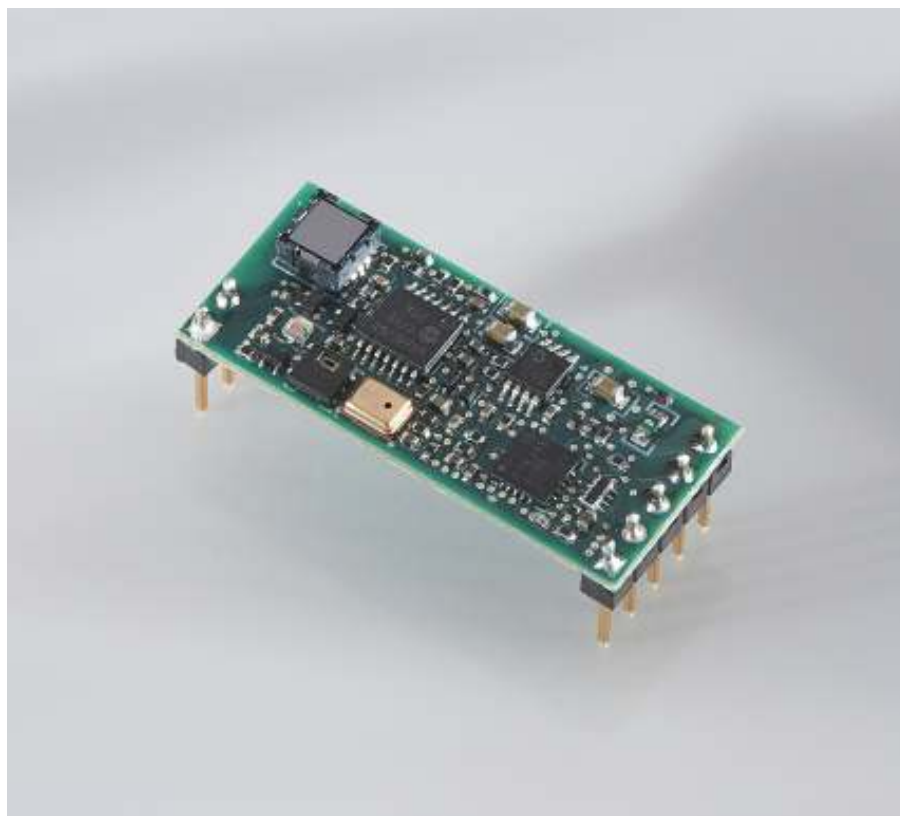
図1 マルチセンサモジュール「AmbiMate」は、占有状況、湿度、温度、空気品質をそれぞれ検知するセンサ機能を統合し、すべてのデータを単一のインタフェースを介して送信する。
