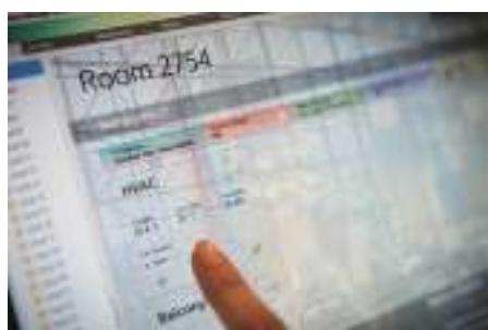
スイソテルのオペレーションスタッフは、コンピュータのタッチボードで、66階に渡る全客室のどんな動きも見逃さない。この写真では、2754号室は占有されておらず、室温が25.4度だということが分かる。(提供:シグニファイ社)
