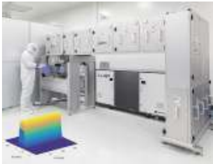
図2 コヒレント社のLineBeam 155システムには、248 nmの短波長光子を照射するLEAPシリーズの150Wのエキシマレーザが搭載されている。左下に示されているのは、生成されるラインビーム形状(長軸方向の幅が155mm、短軸方向の幅が0.3mm)の標準的な3Dプロファイルである。
