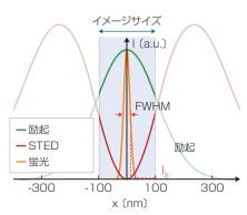
ドーナツ状のSTEDの焦点ビームは、中心で焦点領域から強い光を排除させることで、エリア内のみの分子が蛍光を発する。しかし、最大光度が強いために標本は光褪色を起こし、STEDビームの波長の半分以上に光が分散する。MINFIELDは、回折限界以下のエリア(ドーナツの中心あたり)に視野像を制限する。ここでは、ビーム強度はより抑えられている。そのため、より高い分解能で蛍光シグナルを取得でき、光褪色も大きく抑えられる。(提供:マックス・プランク研究所)
