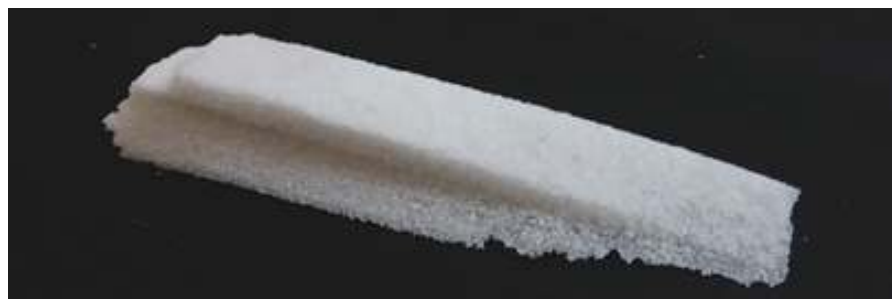
図1 不適切な材料を用いたもの。非晶質の熱可塑性プラスチックであるポリ乳酸(PLA)を使用した粉末床溶融結合。
