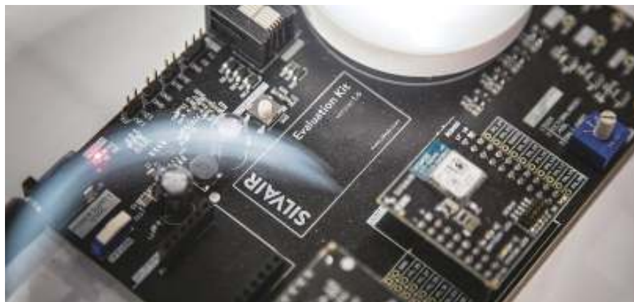
SSL 製品開発者は、シルヴェール社の評価キットを使用することによって、Bluetoothメッシュの機能を試用し、コネクテッド照明製品の設計サイクルを加速化させることができる。
