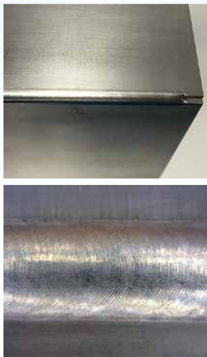
図2 ビームウォブル手法を用いた6061-T6アルミニウムの溶接例。
