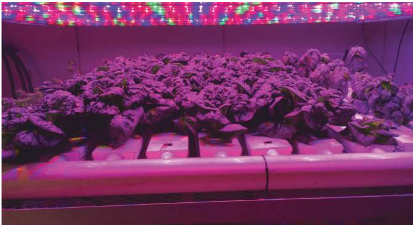
図1 直線形LED植物育成ライトモジュールの例。各モジュールに異なる色のダイオードが装備されている。
