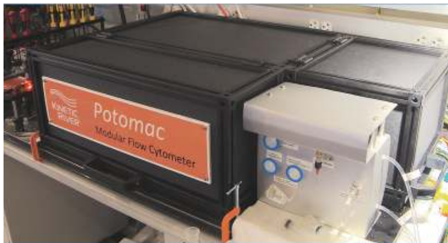
図4 キネティックリバー社のモジュール型フローサイトメータPotomacは、オープンアクセスできるように設計された構成である。国立衛生研究所に納品されたこのユニットは、外部レーザーで動作するようにカスタマイズされた。
