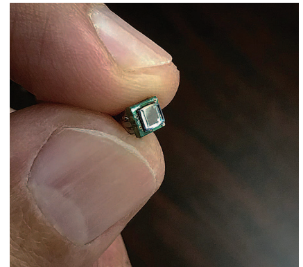
図3 プリント回路基板に実装された小型マルチスペクトルセンサのプロトタイプ。
