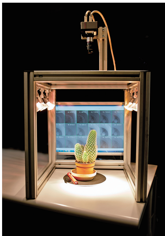
図2 imecが提供するハイパースペクトル・イメージングシステムからは、同じ対象物(この場合はサボテン)でも異なる波長で走査すると異なって見えることがわかる。(画像提供: imec)
