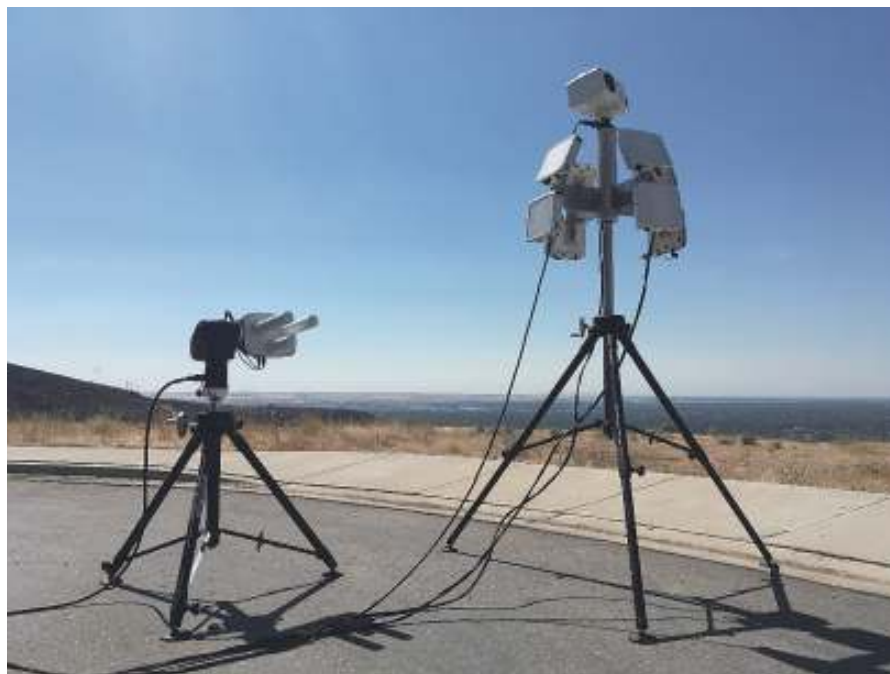
図2 2台のカメラと周波数妨害装置を装備するパンチルト・システムは、ドローンの無力化に使用することができる。(提供:米ブラックセージテクノロジーズ社[Black Sage Technologies])
