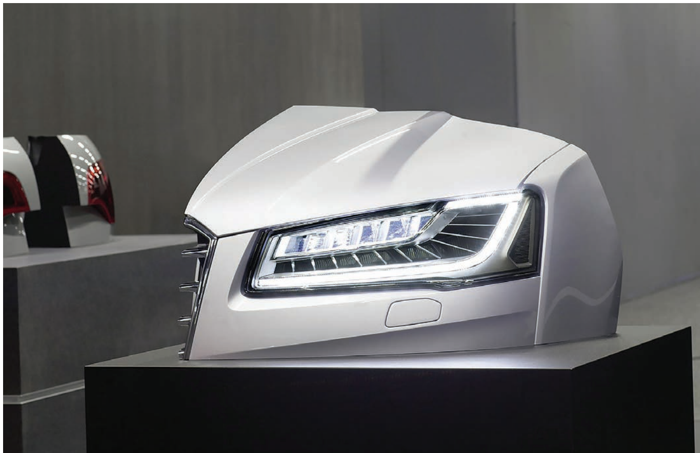
SAE J3069規格が対象とする動的制御のヘッドランプの例として、「Audi Matrix」技術がある。同技術は、近くにいる車両に反応して、ビームパターンを適応させることができる。(提供:アウディ社)
