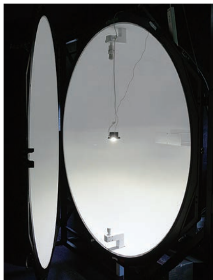
図5 ファンによって補助されたヒートシンク上に配置された150WのLED光源が、積分球の中に吊り下げられている。この測定装置により、総光出力を波長の関数として測定することができる。写真は、光源と照明器具の試験のみを専門とする正式認可試験施設であるThe Lighting Industry Association Laboratoryの設備で撮影されたものである。
