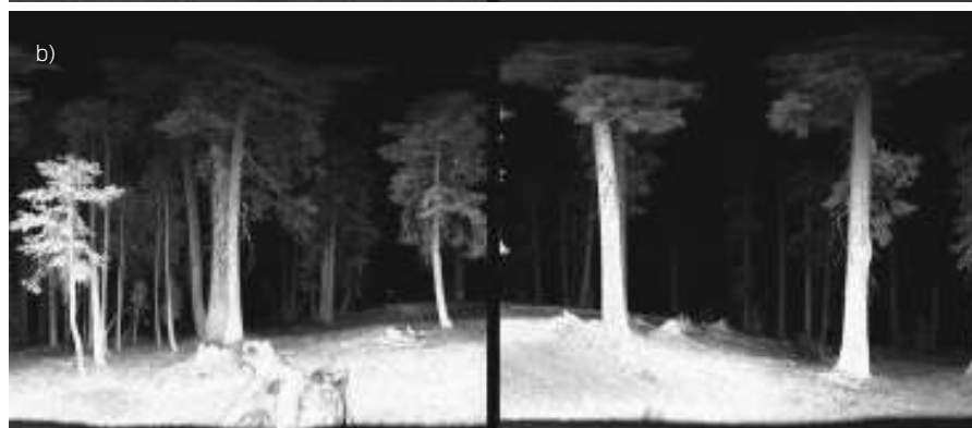
図4 同じ場所を捉えた、DWEL装置の1548 nmチャンネルの画像(a)と1064 nmチャンネルの画像(b)。(提供: マサチューセッツ大ボストン校)
