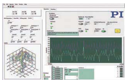
図4 このGUI(Graphic User Interface: グラフィックユーザーインターフェイス)環境に示されているように、パターン化された多軸モーションツールによって複雑なモーションプロファイルがプログラミングされる(提供:PI社)。
