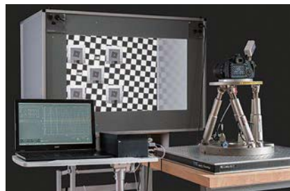
図3 PI社が提供する6軸ヘキサポッドモーションシステム「H-840」は、CIPAが定める加振装置の認証規格に基づいて、手ぶれ補正システムを試験するためのカメラぶれをシミュレーションする（提供：独イメージ・エンジニアリング社）。
