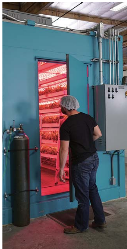
図3 ローカルルーツ社は、葉物野菜の生産を最適化するために、出荷コンテナに収容された農園のLED照明を絶えず調整している。
