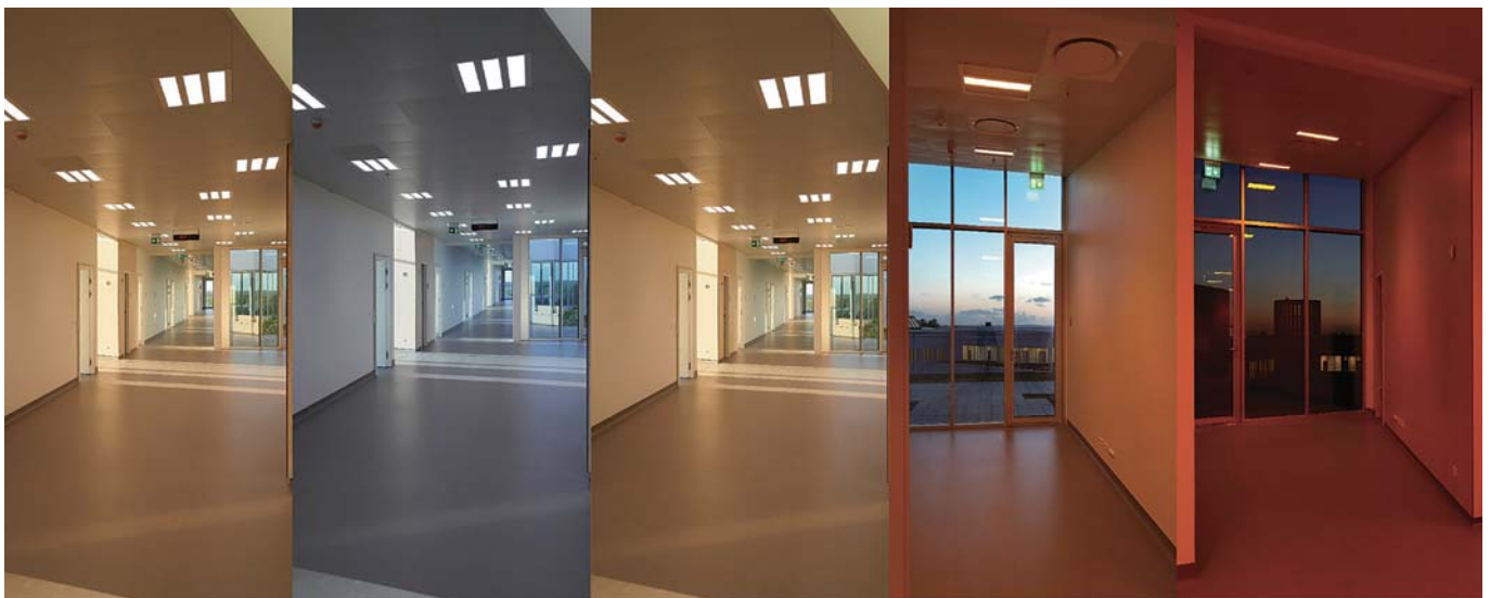
図3 デンマークにあるオーベンロー病院 (Aabenraa Hospital)の精神科病棟において、クロマヴィソ社が開発した概日照明は、さまざまな作業や雰囲気に適した動的で機能的な照明を24時間周期で提供する。
