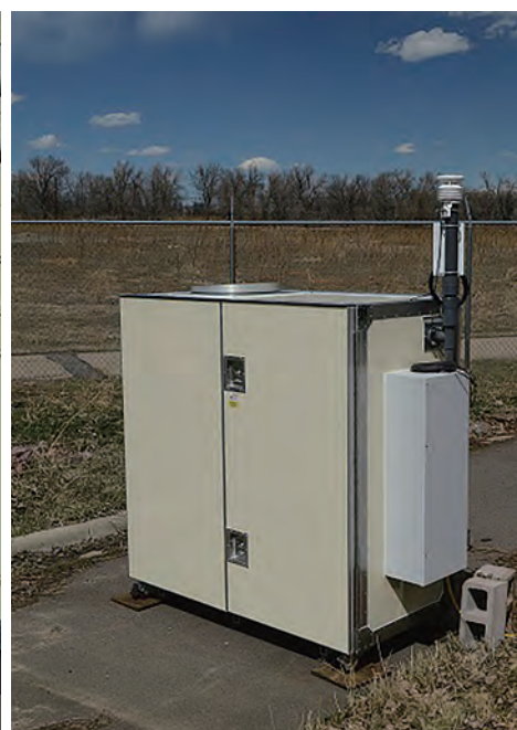
差分吸収ライダ (DIAL) システム (挿入図) は、フォトダイオードの分布ブラッグ反射鏡 (DBR) 注入シードレーザを用いて NASA が開発した (画像提供: NCAR)。
