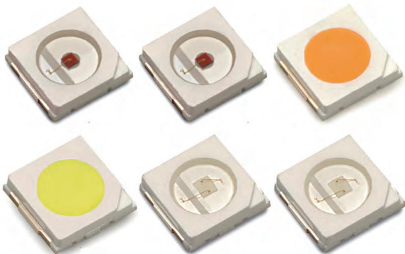
図6 ルミレッズ社の中出力のLuxeon 3535LカラーLEDでは、蛍光体変換を利用して琥珀色(右上)とライム色(左下)のLEDを実現している。
