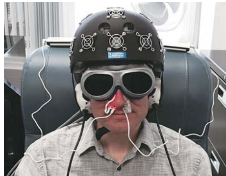
図2 湾岸戦争の退役軍人の疾患における認知改善を目的とする、ボストンVA病院の二重盲検試験で使用するために開発された装置。フォトメデックス社のLEDヘルメット、ヴィーライト社の鼻孔内ダイオード、メドエックスヘルス社のLEDクラスタの耳ヘッドが含まれる。
