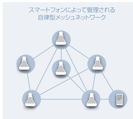
図4 Silvair Meshは、単一のスマートフォンで制御される小規模なメッシュネットワークと、クラウドに接続された専用サーバを備える複雑なネットワークの両方をサポートする。
