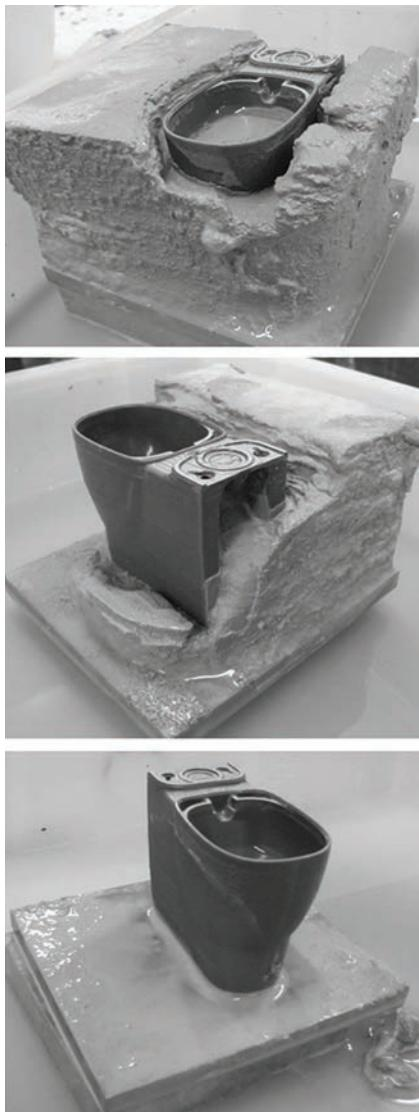
図4 LSD工程を用いて、陶器でできた衛生便器プロトタイプのレーザ焼結後に剥離工程が示されている(BAM連邦材料試験研究所提供図)。
