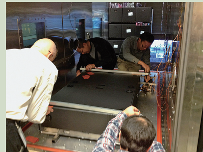
図A 産業グレードの信頼性提供の決め手になるのは、HASS 試験である。ここでは、レーザーを包括的な「シェイク&ベイク」テストにかけられる前に、コヒレント社の技術者が環境テストチャンパ内の除振台に固定している。
