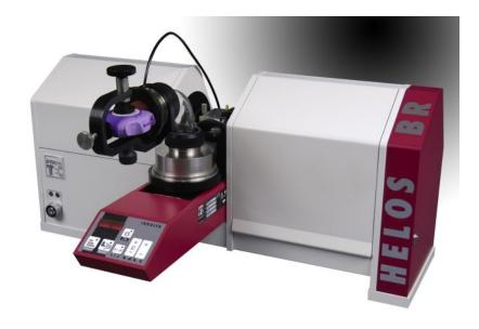
部本体と分散ユニットがそれぞれ独立しており、測定対象物に応じて分散ユニットを選択し測定部本体と組み合 わせて使用する。本体測定部は全ての分散器に共通しているため、分散器の拡張が可能である。
