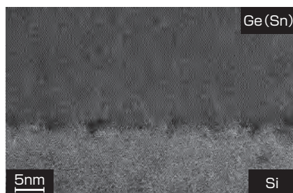
図1 透過型電子顕微鏡(TEM)から、ゲルマニウム/スズ(Ge/Sn)境界の不整合転位が分かる。
