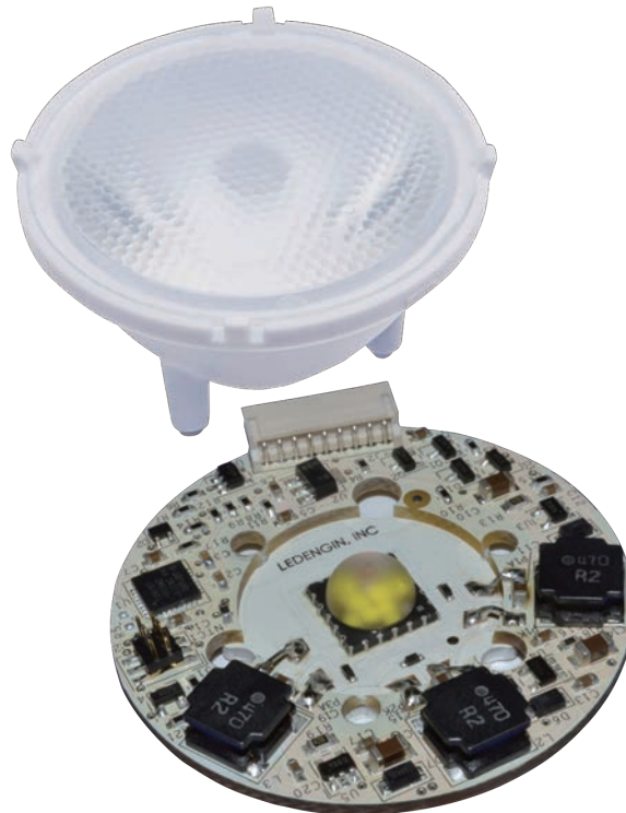
図4 コンパクトなエミッタ、二次光学部品、ドライバ制御基板によって、LEDの利点をすべて維持しつつ、ハロゲン式の調光機能を簡単に実現することができる。
