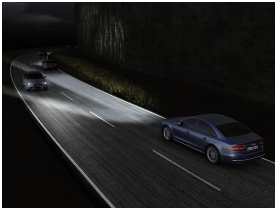
図5 前面カメラにより、Matrixヘッドライトはビームを動的に調整することが可能で、対向車の運転者のまぶしさを軽減する。
