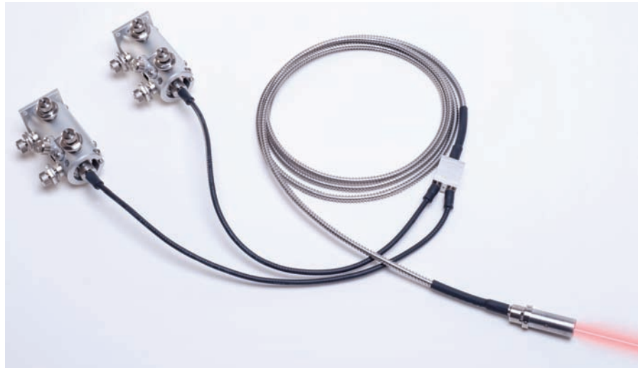
図2 2列のkineFLEX-Hydraファイバ伝送システムは、平行で同一線上のビームを形成する、統合出力ビーム光学系を含む。このシステムには2つのkineMATIX マニピュレータが含まれており、アライメントおよびそれぞれのレーザーをファイバに接続するための各入力端である。レーザーを寿命で交換するときに、レーザー側においてファイバから切り離すレーザーを選択することで、ファイバは「その場に ( in situ )」残すことができ、出力端を機器内に埋め込んだままにできる。これによって、整備や放熱のためにレーザーをより便利な場所に設置できるようになる。
