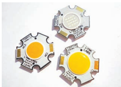
図2B リンクラブス社の12VのAC LED採用COBパッケージ。
