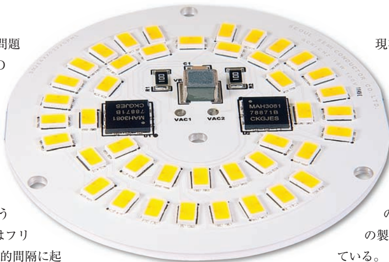
図1 220Vにおいて、ソウル半導体社の16Wのダウンライト・アセンブリは、3000KのCCTと120°の視野角で1250lmを実現する。
