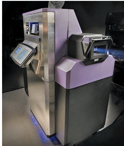
図2 コダック社のレーザー投写技術による3D映写機の試作品(右はその内部)は映画産業に対して、明るい3Dディスプレイ、高いコントラストおよび低い運用コストを実証している。
