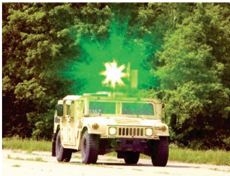
図1 ハンヴィー(Humvee:高機動多用途装輪車両)からレーザーダズラーを使用する様子(提供:合同非殺傷兵器プログラム)
