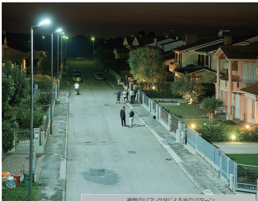
図1 「DEFLECTO」では、複数の反射 (複数のリフレクタ) を利用して、ポイント光源のグレアを抑制する。図の下部に示したのは、照明器具からの配光パターンである (提供: アリアナ社)。
