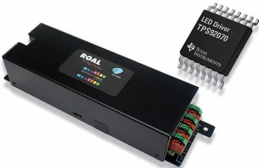
図2 ドライバとは、回路全体からLEDを除いた部分のことである。ドライバには、ドライバICを1つ以上搭載するものもあれば、まったく搭載しないものもある。図の左に示したのは、イタリアのロアル・エレクトロニクス社 (ROAL Electronics) 製のドライバである。図の右に示したのは、米テキサス・インスツルメンツ社 (Texas Instruments) 製のドライバICだ。両者はともにLED照明に使用される。
