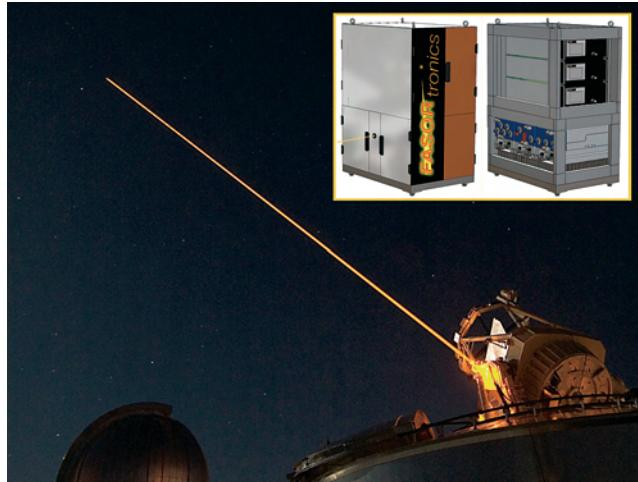
図1 スターファイア光放 射施設の3.5m天体望遠鏡からの50W FASOR ビームは、2005年4月26日の夜空の中間層ナトリウム層にガイド星を生成した。FASORトロニクス社が製品化したレーザ装置(挿入図は装置の外観と容器パネルを外した状態)は単一周波数IRレーザモジュールと和周波数発生器から構成されている。(資料提供:FASORトロニクス社)
