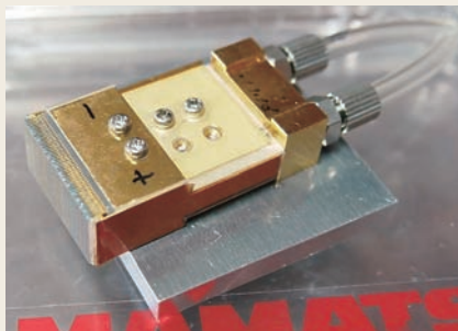
図3 5kWを出力するレーザーダイオード(浜松ホトニクス製)。
