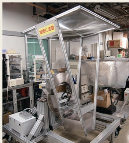
図3 太陽光励起レーザーのための集光フレネルレンズおよび太陽追尾システム。
