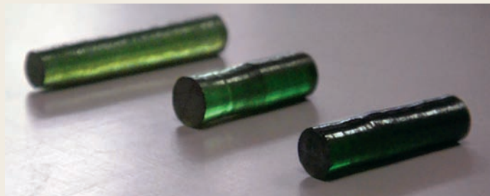
図1 レーザ媒質のバナデート結晶。写真手前ほどCrの濃度が高い。
