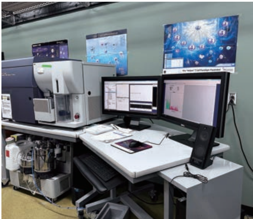
図1 アーカンソー州立大では、フローサイトメータで細胞の物理特性を計測するためにレーザーが使用されている (提供:アーカンソー州立大/アーカンソー州リサーチアライアンス)
